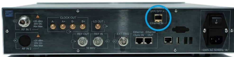
Рис. 1. Разъем SFP/SFP+ для управления прибором по Ethernet
